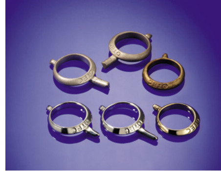
Необработанные отливки ювелирных изделий после шлифовки в ECO-Mini «wet» и полировки в ECO-Mini «dry»
