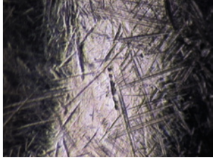
Поверхность изношенного кольца, увеличенная в 200 раз
